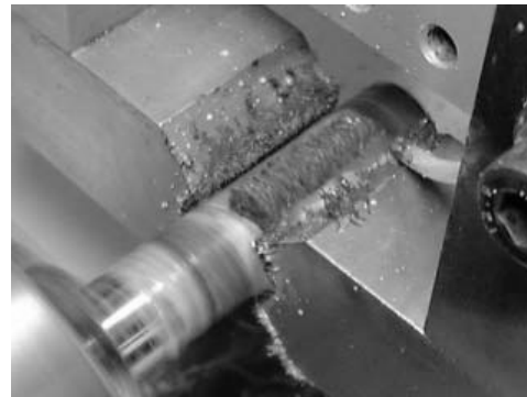
Рис. 2 Магнітно-абразивна обробка циліндричної заготовки
